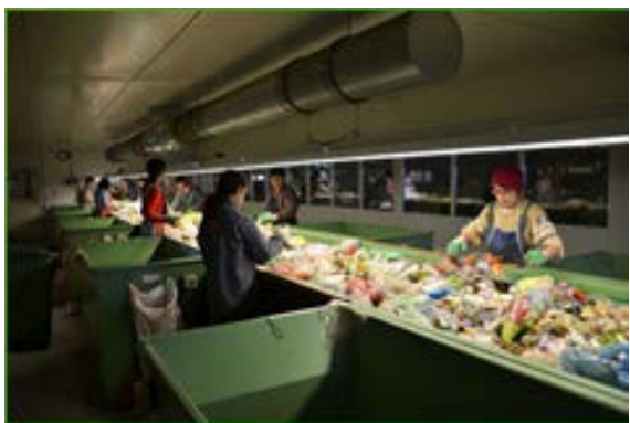
Stație de sortare manuală
